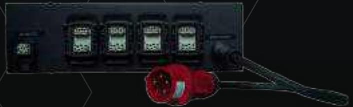
固定速度TWモデルは、「PVC-TW04R」4chコントローラー、または「PVC-TW01R」1chコントローラーを介して制御されます。これらのコントローラーには、各チャンネルのUP/DOWNスイッチと緊急停止スイッチがあります。コントローラーは最大24ユニット(96チャンネル)までリンクでき、HartingおよびCEE 16Aコネクタが装備されています。また、DMX512ショーコントロールカードも装備できます。
